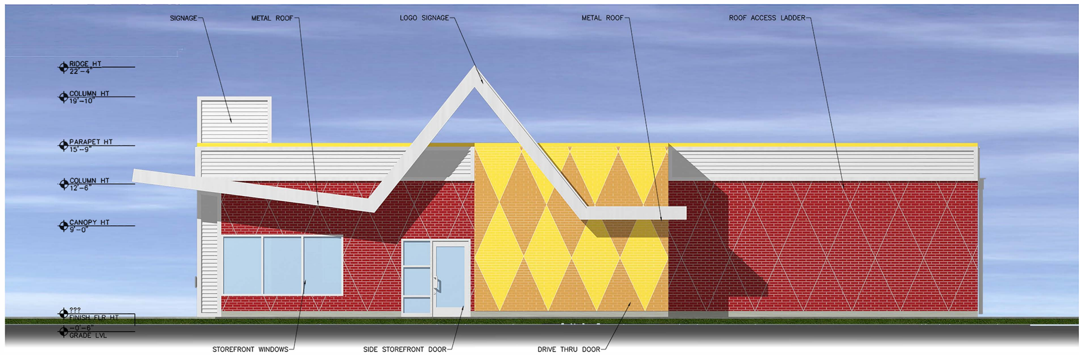
2 RIGHT ELEVATION SCALE: 1/4" = 1'-0"
