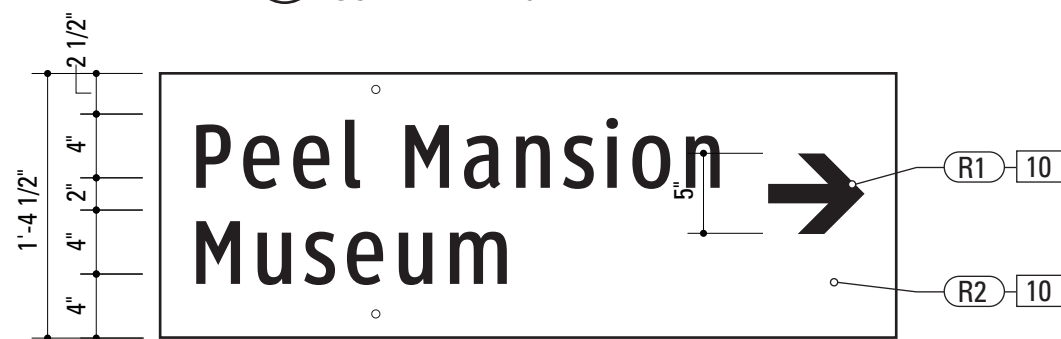
3 MESSAGE PANEL LAYOUT: VDIR.1-3 SCALE: 1" = 1'-0"
