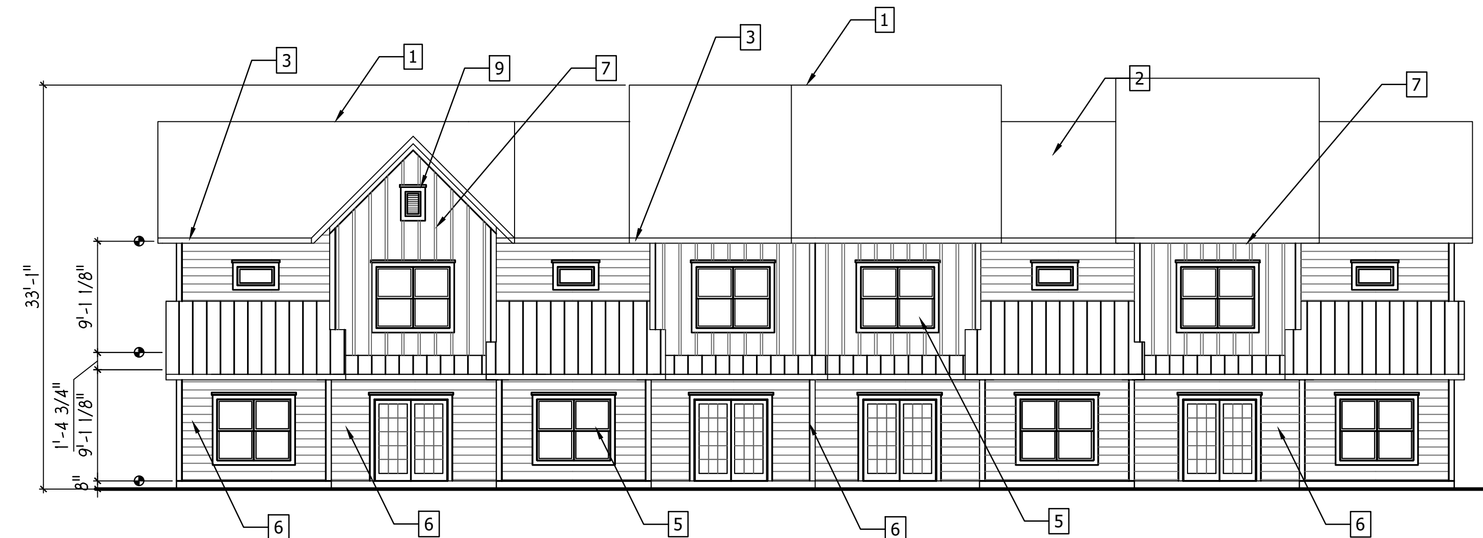
2 REAR ELEVATION T1 & T3 A11.3 SCALE: 1/8" = 1'-0"
